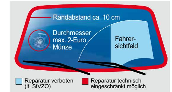
**Bei der Reparatur** wird ein sehr dünnflüssiges Spezialkunstharz unter Druck in das Einschlagzentrum der Schadstelle gepresst. Anschließend wird das Harz mit einer UV-Lampe gehärtet, überschüssige Harzreste entfernt und fein poliert. **Wichtig:** Bei einer Voll- und Teilkaskoversicherung ist die Scheibenreparatur in der Regel kostenlos bzw. Ihre Versicherung übernimmt die Kosten.\*
